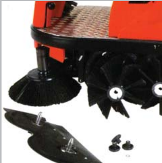
Der werkzeuglose Walzen- und Filterwechsel. The change of rollers and filters without tools.
