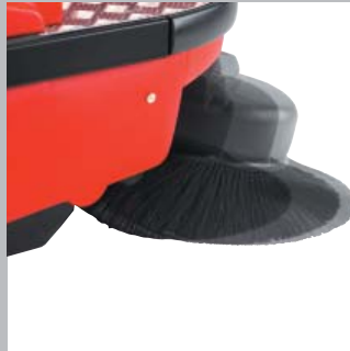
Die selbstausweichenden Seitenbesen. The lateral brooms which independently avoid obstacles.
