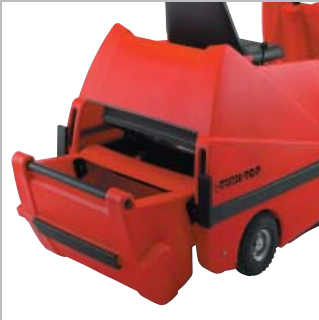
Der besonders große, stabile aber trotzdem leichte Staubbehälter. The particularly large, stable, but nevertheless light dirt collector.
