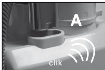
Setzen Sie das ovale Rohr komplett mit Griff vollständig in den oberen Sitz der Maschine A ein.
