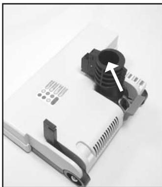
Desenganchar la base de la máquina (véase capítulo montaje máquina). Controlar y eventualmente eliminar la obstrucción del conducto ayudándose con el tubo de la aspiradora de polvo o con una escobilla flexible.
